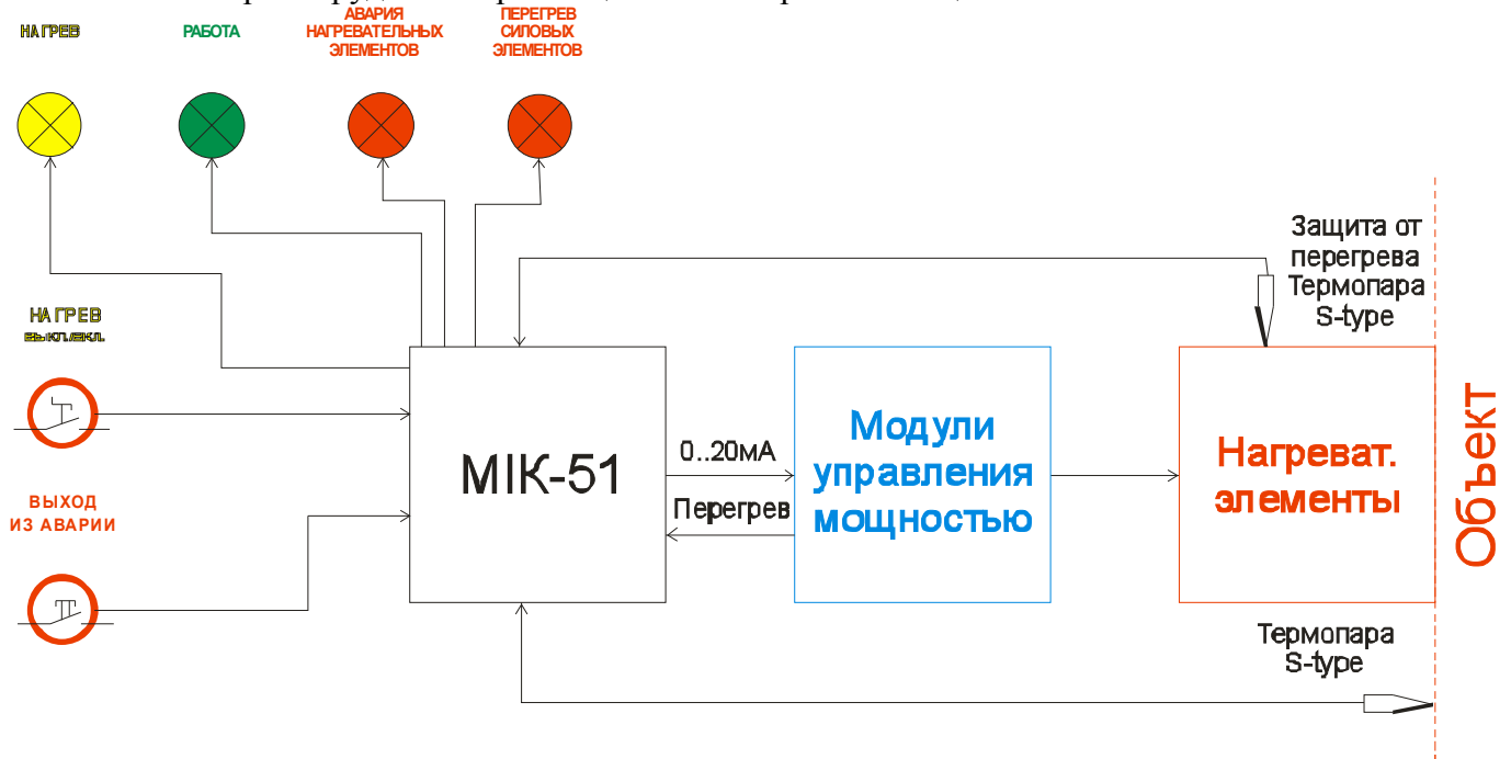
Рисунок 1 — Функциональная схема канала регулирования температуры
